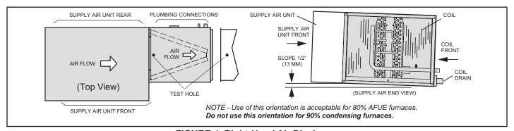
FIGURE 4. Right-Hand Air Discharge
